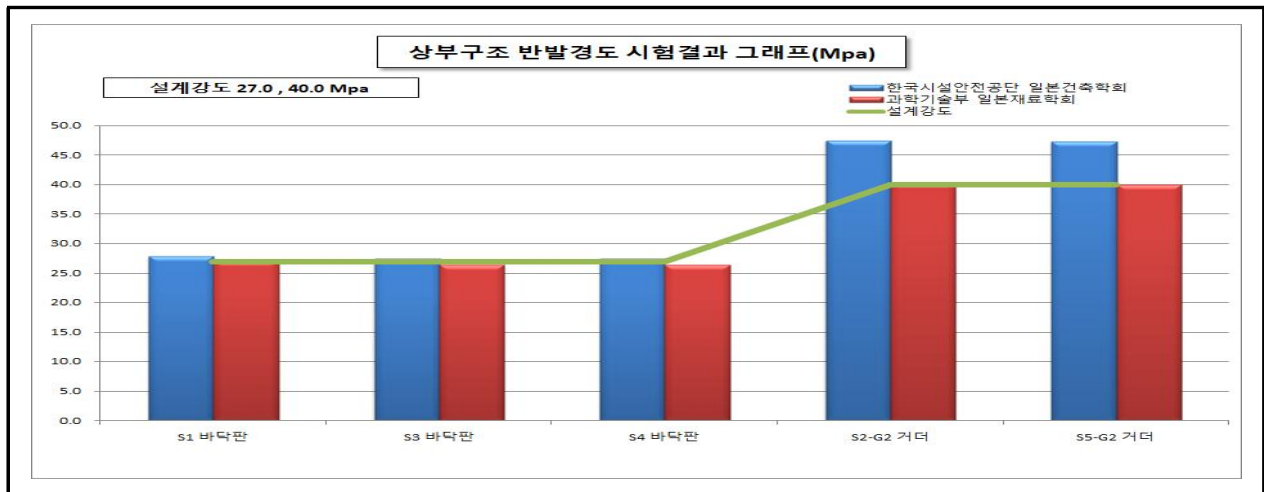
【그림 3.4.5】 영천방향 상부구조 반발경도시험 측정결과
