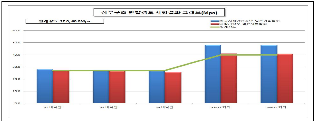
【그림 3.4.3】 상주방향 상부구조 반발경도시험 측정결과
